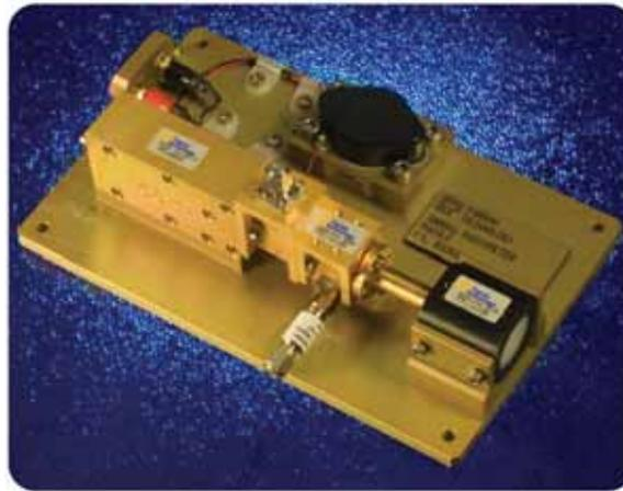
300 GHz Radiometer
